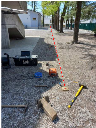
Foto 1 – Traccia dello stendimento MASW, postazione H/V-1,
