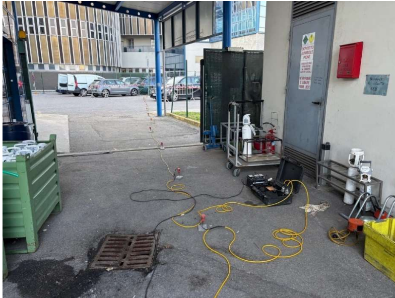
Foto 5 – Stendimento MASW in direzione Sud e strumentazione di registrazione
