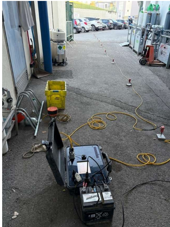
Foto 6 – Stendimento MASW in direzione Nord e strumentazione di registrazione
