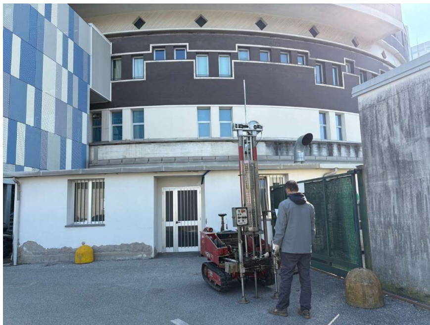
Foto 3 – Prova penetrometrica dinamica SCPT3
